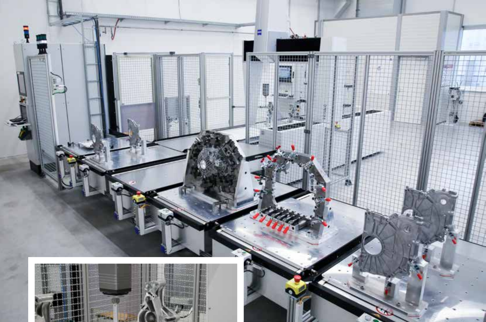
Highlight des Messraums im neuen Werk 4 ist eine Koordinatenmessmaschine Zeiss PRISMO navigator , die über ein Palettensystem mit sechs Palettenplätzen sowie zwei Manipulationsplätzen automatisch be- und entladen wird. (Alle Bilder x-technik)
